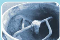
นำเถ้าที่เหลือจากการเผา มาผสมกับปูนซีเมนต์
